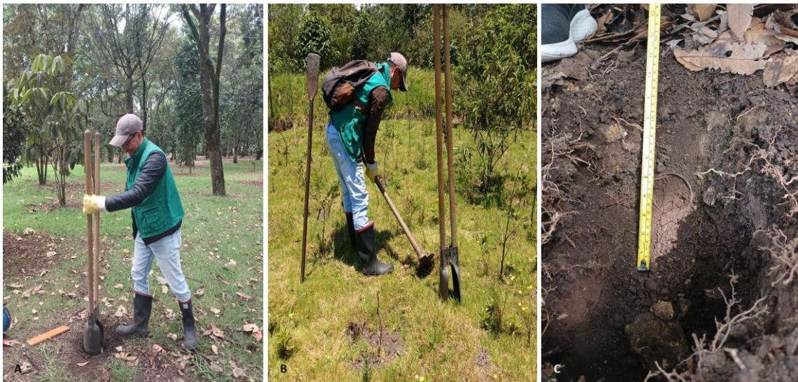
Fotografía 1. Colecta de muestras de suelo con paladraga (A), uso de azadón (B) y extracción de muestras para densidad aparente con cilindro metálico (C).
