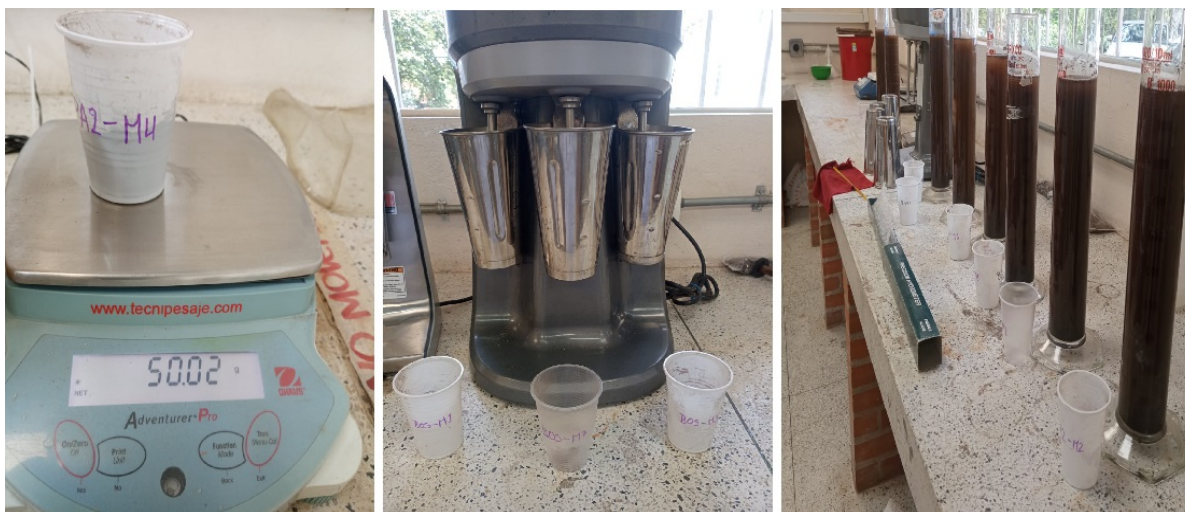
Fotografía 3. Procedimiento para el análisis de textura del suelo (A). pesaje de las muestras (B), separación de las diferentes texturas en la batidora (C). disposición de las probetas para el llenado con agua destilada y posterior agitación.
