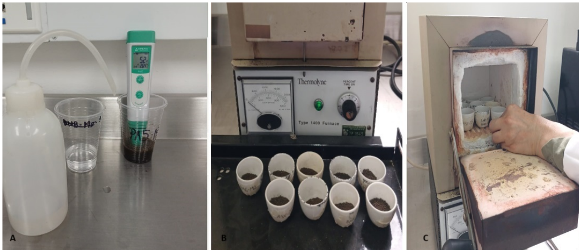
Fotografía 2. Procesamiento de muestras en el laboratorio para obtención de pH del suelo (A). Muestras dispuestas en crisoles (B) y muestras en mufla para determinación de carbono orgánico del suelo.
