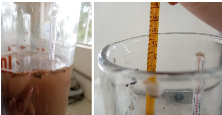
Fotografía 4. Registro de temperatura con termómetro
